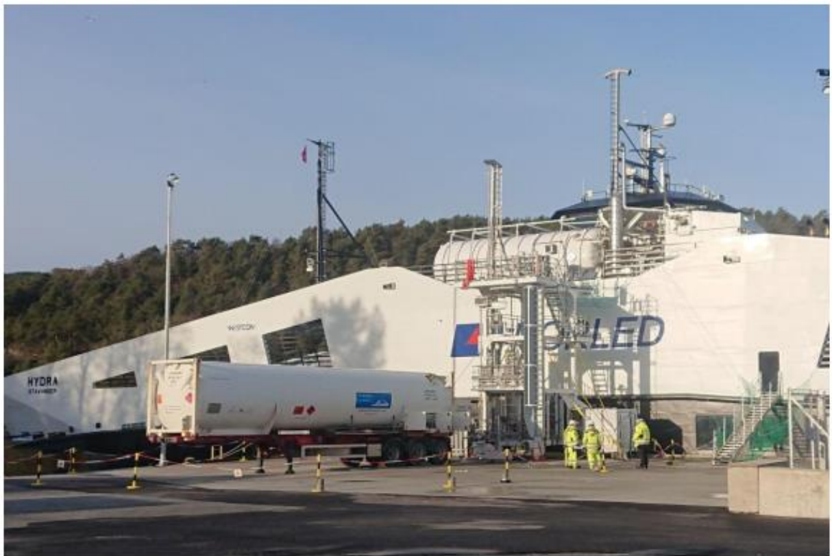
Hình 20: Tháp tiếp nhiên liệu hydro lỏng di động do Norled thiết kế và sở hữu được gắn vào một xe moóc ống, tiếp nhiên liệu cho phà chở khách Hydra. Ảnh: Norled AS.
