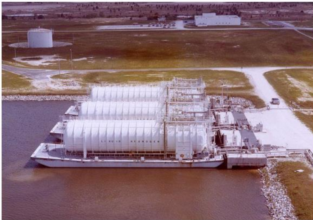
Hình 24: Sà lan hydro lỏng neo đậu tại Trung tâm Vũ trụ Stennis năm 1977. Nguồn: NASA/Stennis.
