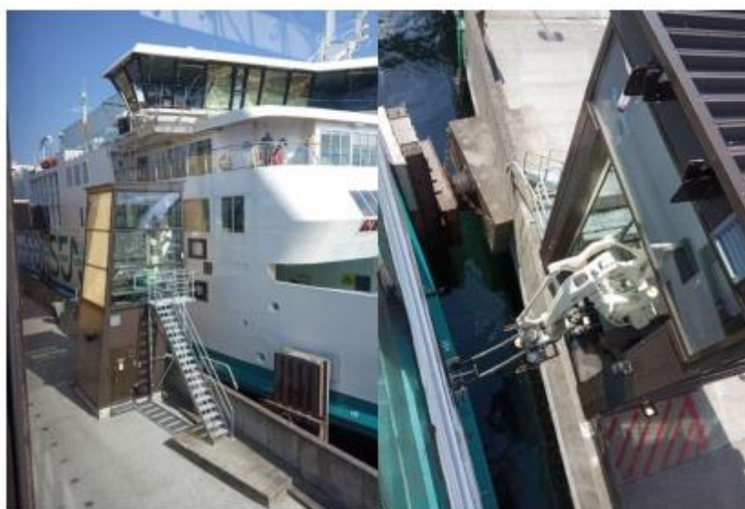
Hình 2: Kết nối sạc 10.5 MW bên bờ cho phà chở khách Aurora af Helsingborg và Tycho Brahe
