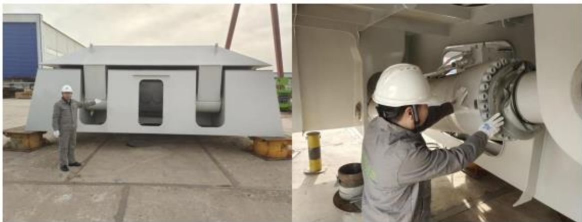
Hình 26: Ví dụ về nền móng cánh buồm rotor gấp bao gồm xi lanh hệ thống nghiêng. Ảnh: Dealfeng New Energy Technology Ltd.).
