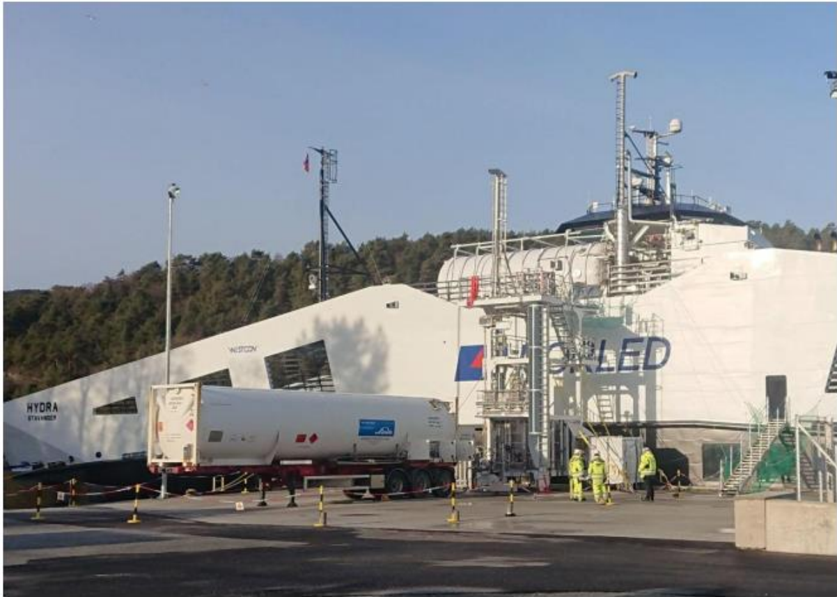
Hình 5: Tháp tiếp nhiên liệu hydro lỏng di động do Norled thiết kế và sở hữu được gắn vào một xe moóc ống, tiếp nhiên liệu cho phà chở khách Hydra (Nguồn: Norled)
