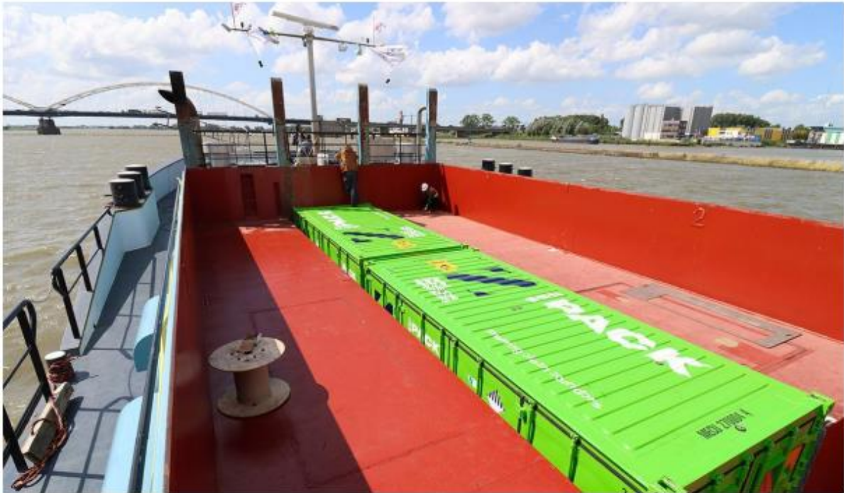
Hình 6: ESS có thể thay thế trong container ISO 20 foot đang hoạt động trên tàu nội địa Alphenaar (ảnh: Zero Emission Services).
